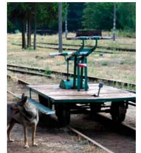
Mit Handhebel betriebene Draisine Foto: Pleple2000 CC BY-SA 3.0 bei Wikipedia
