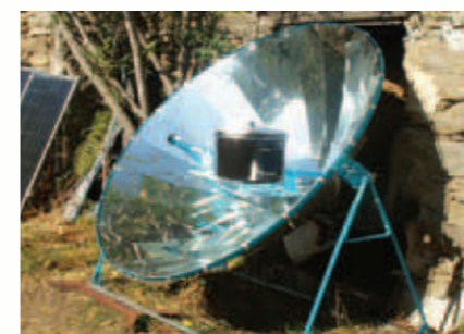
In der Mitte des Solarkochers wird ein schwarz lackierter Topf platziert.
